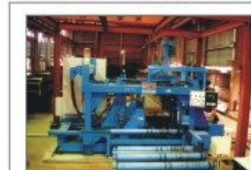
DAIDO DNFC1500Ha H型鋼三軸NC鑽孔機
