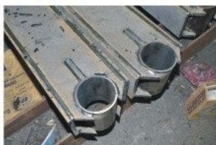
預力鋼棒固定構件製作
