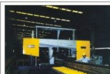
CONSEN SH75150DM H型鋼雙角度帶鋸機
