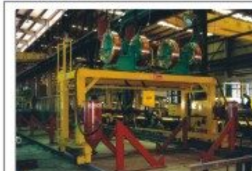
LINCON DC1500A, AC1200A 門型組合型鋼及箱型柱四極潛弧電焊機
